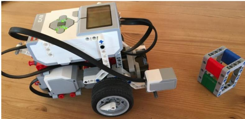
Der Roboter soll bei grün losfahren und bei rot anhalten. Baue auch passende Töne und Farben für den EV3-Stein ein. Wie weit etwa darf das Objekt max. entfernt sein, damit die Farbe noch erkannt wird?
