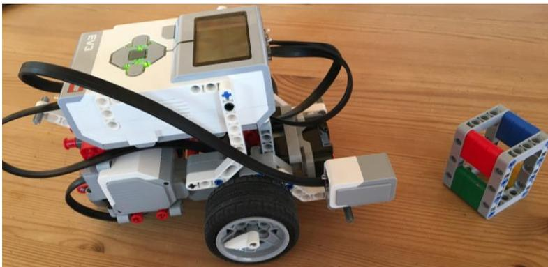
Der Roboter soll der Farbe *Blau* folgen mit einer Rechts- und *Gelb* mit einer Linkskurve. Ansonsten soll er geradeaus fahren und bei *Rot* stoppen
