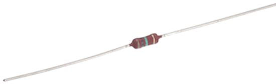
Hier im Bild ist ein Kohleschicht-Widerstand 0.3W zu sehen. Dieser besitzt nur 4 Ringe, die ersten zwei Ringe sind für die ersten zwei Ziffern, der dritte Ring für die Anzahl Nullen. Der letzte Ring - von den anderen drei etwas abgesetzt - gibt den Toleranzwert ( $\pm 5\%$ ) an.
