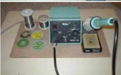
*Komfortabler sind die Lötstationen. Auf dem Bild zu sehen sind ausserdem zwei Rollen Lötzinn (links hinten) sowie Lötzinn-Sauglitze in verschiedenen Breiten (links vorne).*
