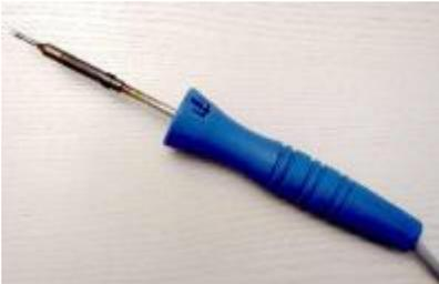
*Hier ein weiterer günstiger LötKolben. Leider hat dieser für Elektronik- und Modellbauarbeiten eine völlig unbrauchbare Lötspitze. Wie auf dem Detailbild erkennbar ist diese vorne nicht zugespitzt, sondern einfach abgeflacht.*
