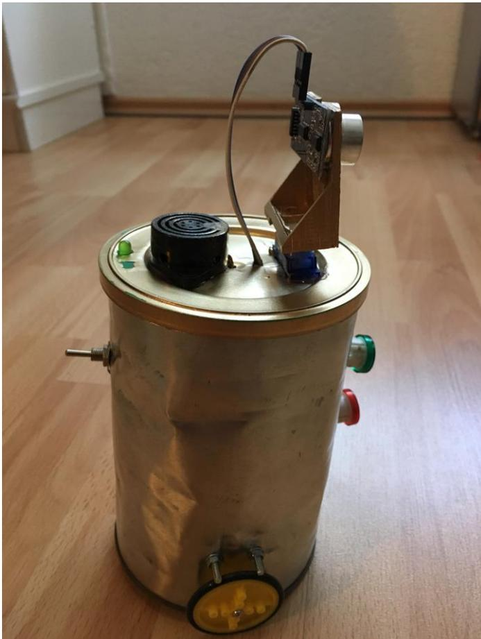
Die Maske für den Ultraschallsensor wurde mit einem 3D-Drucker (Ultimaker) gedruckt. Vorlagen zu solchen und ähnlichen Teilen gibt es hier:
