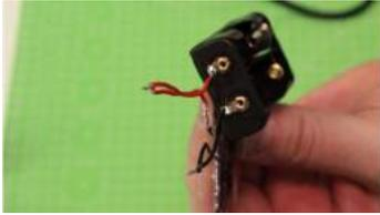
Verbinde die Kabel vom Solarpanel und vom Akkuhalter miteinander. Nutze eine Zange dafür!
