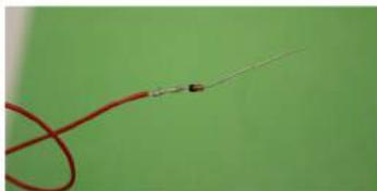
Verbinde die Diode mit einem Stück vom roten Kabel. Achte darauf, dass die schwarze Ecke der Diode zum Kabel zeigt
