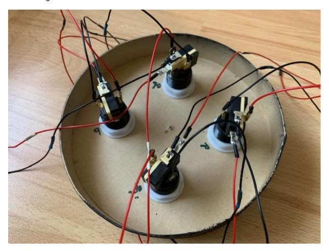
Verkabelung für Buzzer und Brücke für die Minus-Reihen:
