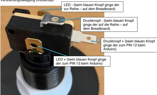
Die anderen Druckknöpfe werden gemäss Code genau gleich verdrahtet.
