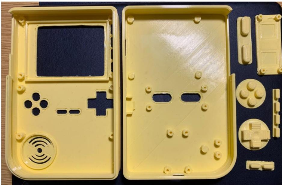
Löcher vorbohren mit Schrauben. Komponenten zuerst reinlegen und schauen, ob alles passt.
