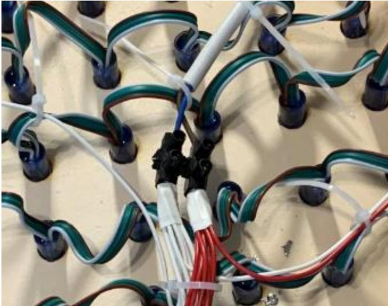
Die Anschlüsse am Arduino Nano: PIN 6 Daten (von grün auf gelb), Plus (5V) (von rot auf orange), GND (von weiss auf grün)
