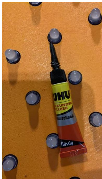
Mit Flüssigleim die LEDs von oben verleimen.
