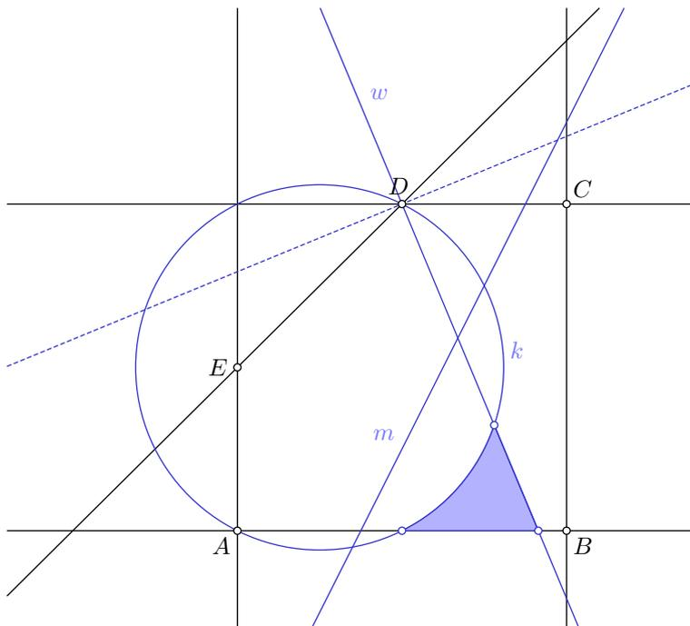
Die Punkte, welche gleich weit von  $E$  und  $B$  entfernt sind liegen auf der Mittelsenkrechten  $m$  von  $EB$ . Die Punkte, von denen aus die Strecke  $DA$  unter einem rechten Winkel gesehen werden, liegen auf dem Thaleskreis  $k$  über der Strecke  $AD$ . Die Punkte, welche den gleichen Abstand zur Geraden  $ED$  wie zur Gerade  $CD$  haben sind die beiden Winkelhalbierenden dieser beiden Geraden, wobei hier nur die Winkelhalbierende  $w$  in Betracht gezogen werden muss.
