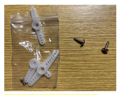
Zum Anschrauben des Rades kannst du die beiden Schrauben aus dem Servo-Säcklein nehmen.
